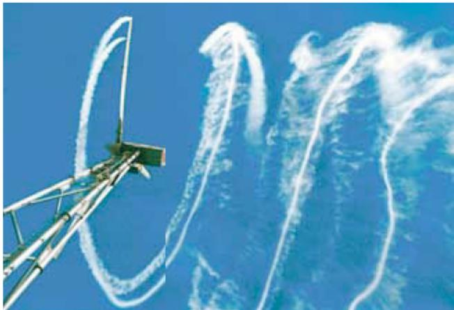
Abb.22: Turbulenzen hinter dem Rotor [15]
